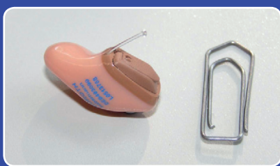
Abb. 4: CIC (Completely-in-the-canal)-Hörgerät im Größenvergleich zu einer Büroklammer
